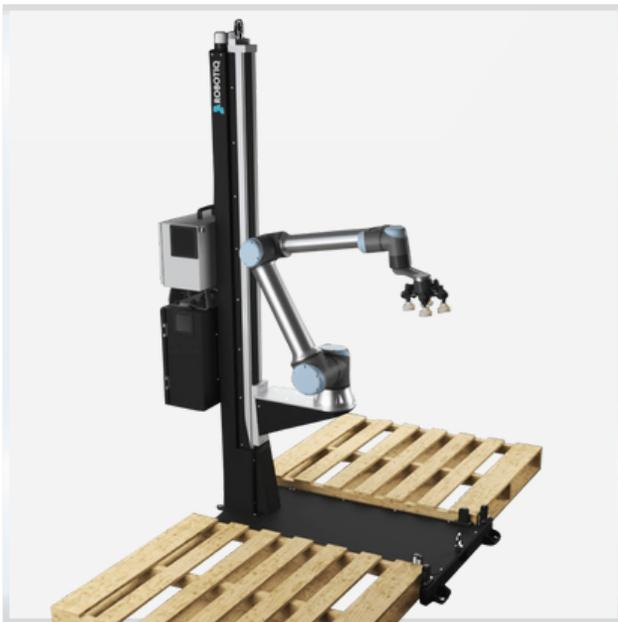
Solution de palettisation robotique montée sur un axe vertical commandé par logiciel.
