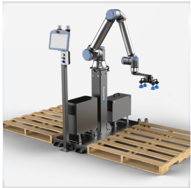
Solution de palettisation robotique montée sur une colonne qui doit être ajustée manuellement.
