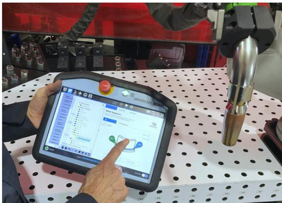
Le URCap de soudage de Techjig vous permet d'accélérer la programmation de vos pièces. Réaliser des soudures en moins de 2 minutes. Simplifier des opérations complexes à l'aide des nombreuses fonctions: oscillation de la torche, soudure par pas et encore plus. Compatible avec tout modèle de soudeuse.
