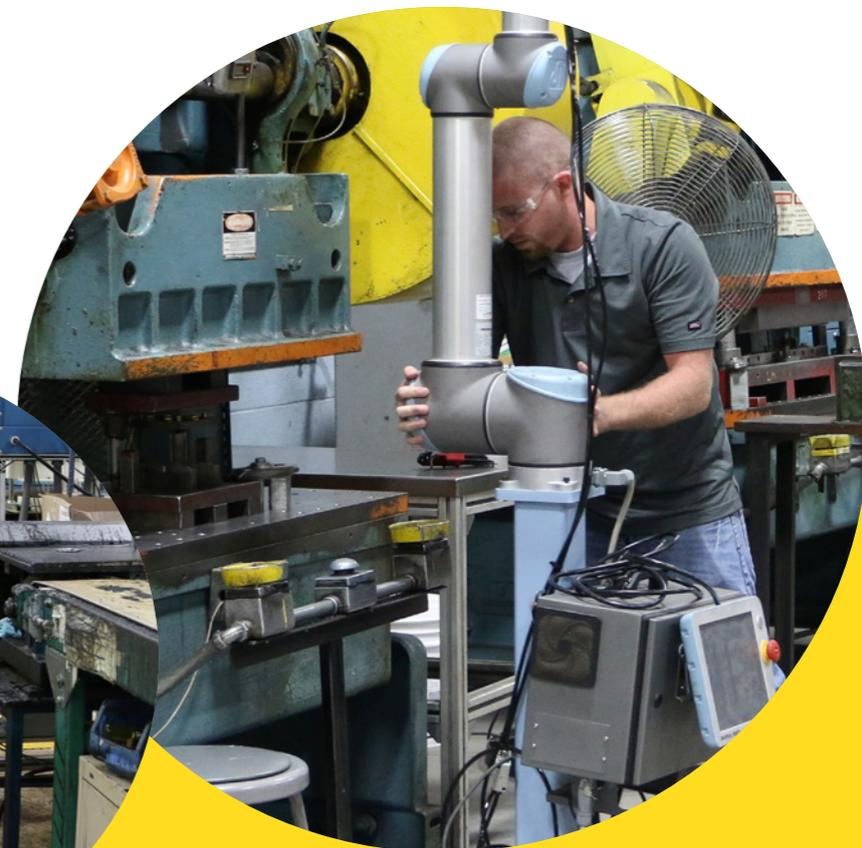
➔ **La plupart des applications mettant en œuvre un cobot ne nécessitent pas de capteur ou de périmètre de sécurité, en fonction de votre analyse des risques. Les fonctionnalités intégrées respectent les exigences de sécurité et les limites de couple en vigueur. Ainsi, le cobot s'arrêtera automatiquement, ne provoquant aucune blessure en cas de collision avec une personne.**
