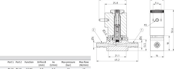
Ø6 \*\* Ø6 \*\* AP-621L-DR3-GP\* 0.3 2/2 NC 0.8 10 43 AP-621L-FR3-GP\* Ø6 \*\* Ø6 \*\* 1 8 53 2/2 NC 0.45 AP-621L-HR3-GP\* Ø6 \*\* Ø6 \*\* 2/2 NC 1.2 0.57 6 53 Ø6 \*\* Ø6 \*\* AP-621L-LR3-GP\* 1.6 0.78 4 52 2/2 NC AP-621L-DW3-U7\*OX2 Ø6 \*\* 2/2 NC 0.8 0.3 10 43 AP-621L-FW3-U7\*OX2 Ø6 \*\* Ø6 \*\* 2/2 NC 1 0.45 8 53 2/2 NC AP-621L-HW3-U7\*OX2 Ø6 \*\* Ø6 \*\* 1.2 0.57 53 6 Ø6 \*\* 52
